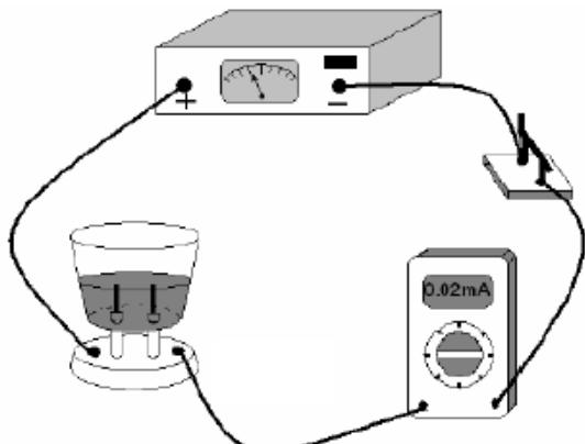
لدينا الدارة الكهربائية التالية، ملأنا محلول الماء النقي بالملح عند غلق الدارة وجدنا شدة التيار الكهربائي  $I = 0.02\text{mA}$  و عندما نضيف قليل من الملح للماء النقي نتحصل على محلول مائي للملح تركيزه  $I_1 = 325\text{ mA}$  نجد  $C_1 = 100\text{ gL}^{-1}$
