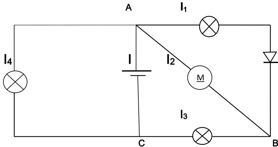
B - حدد على الرسم البياني اتجاه التيار الكهربائي في كل فرع من فروع الدار الكهربائية
