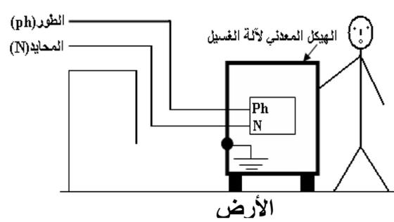
أ- تأمل الرسمين ثم حدد الرسم الذي يتعرض فيه المستعمل إلى صدمة كهربائية إذا حصل تسرب للتيار الكهربائي في الهيكل المعدني لآلة الغسيل معلا إجابتك؟
